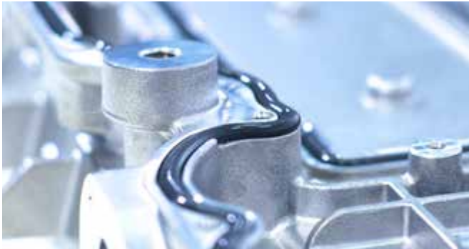
Dichten – Barriere vor äußeren Einflüssen
