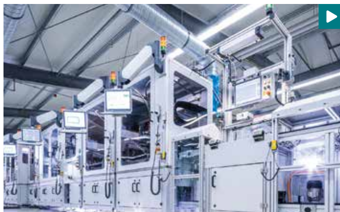
Bild 4: Die automatisierte Produktionslinie bewältigt Dosieren, Versiegeln, Verschrauben, Crimpen und Prüfen in einer Anlage (Bild: Scheugenpflug GmbH)
