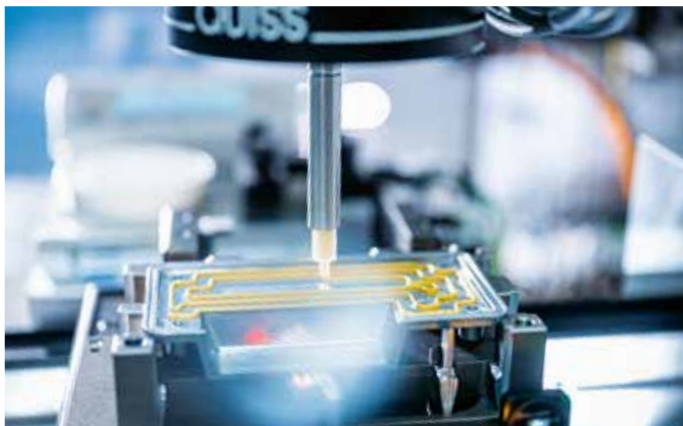
Bild 3: Dank Integration der Inspektion in die Dispensing-Zelle wird die Applikation zeitgleich mit dem Klebstoff- und Dichtmittelauftrag geprüft und überwacht (Bild: Scheugenpflug GmbH)
