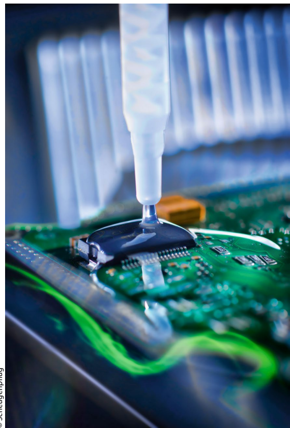
Bild 1 > Nur gut geschützte Elektronik garantiert Sicherheit und hat eine lange Lebensdauer.
